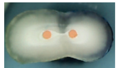
Kép az optikai mikroszkópból a mikro tömörségi vizsgálat során (kapilláris teszt): Nincs festék behatolás
